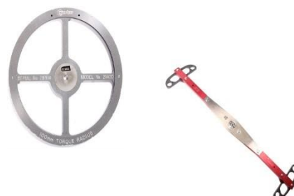
▲ 英國 Norbar 扭力傳感器校正天平
